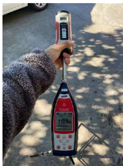
1º Dia - Calibrador sonoro ligado e acoplado ao microfone antes da medição
