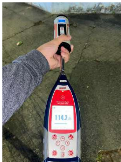
2º Dia - Calibrador sonoro ligado e acoplado ao microfone antes da medição
