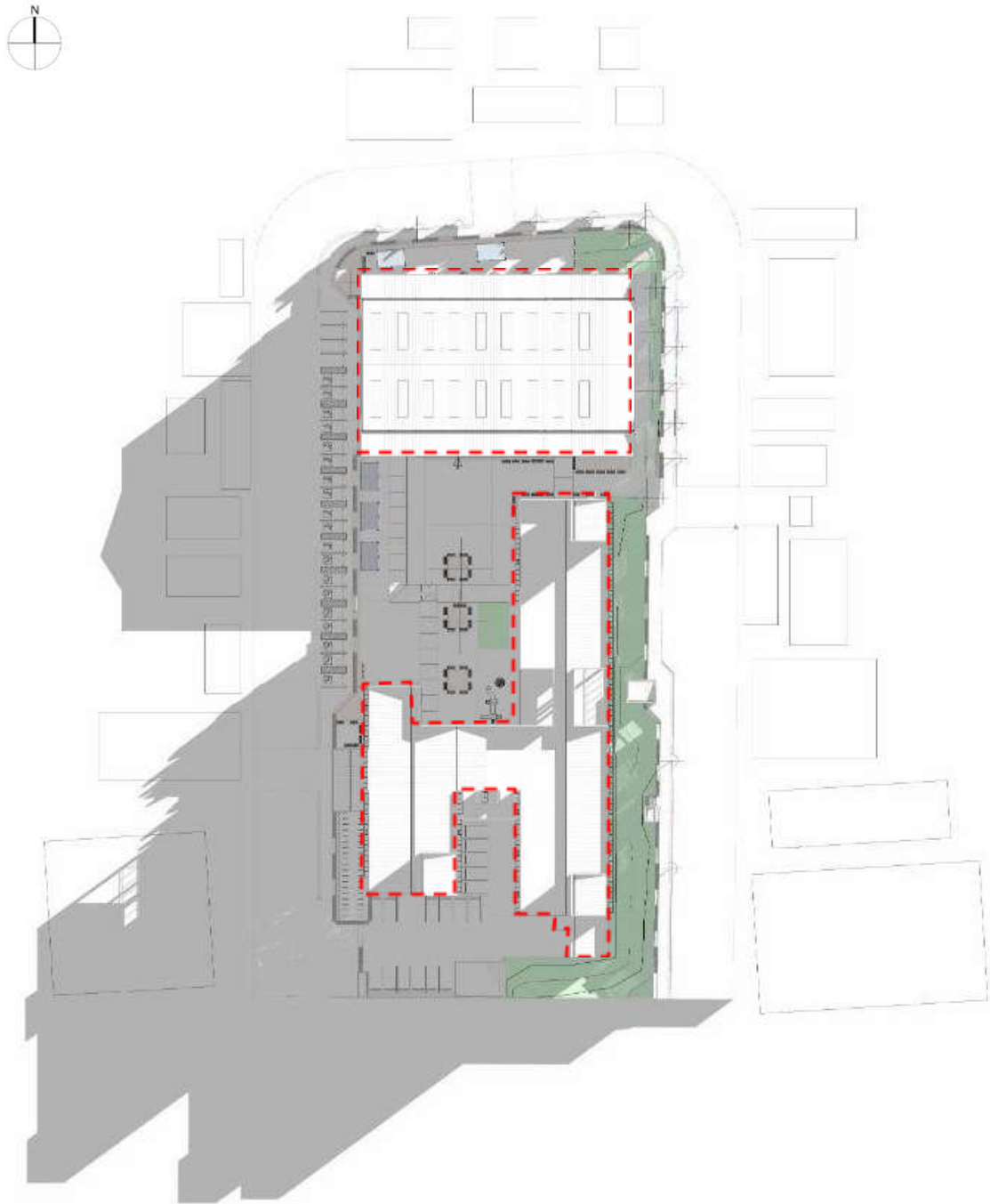
Imagem 40 - Estudo de iluminação - Simulação de insolação local no solstício de inverno às 8h. Elaborado no software Revit Autodesk
