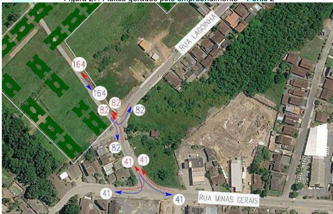
Figura 27: Fluxos gerados pelo empreendimento – Ponto 2
