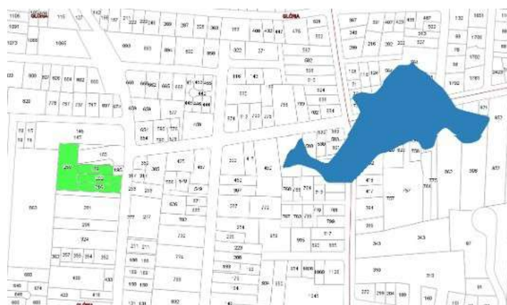
Figura 3: Mancha de inundação em relação aos lotes
