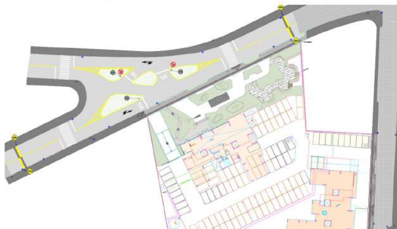
Figura 21 – Sinalização horizontal e vertical – pós obras
