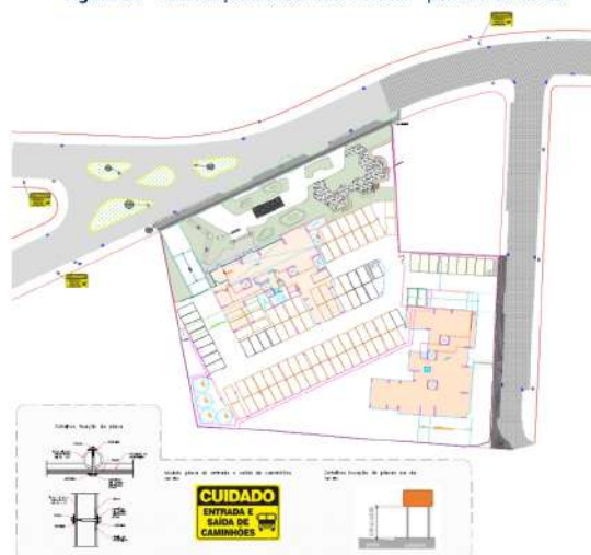
Figura 20 – Sinalização horizontal e vertical – período de obras
