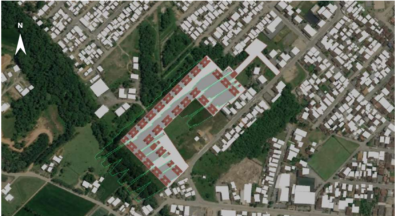
Figura 30 - Simulação de insolação no solstício de inverno às 8h.
