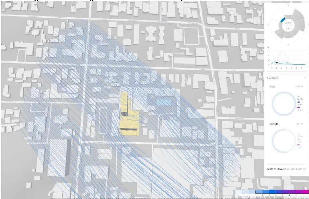
Figura 26 - Modelagem Aerodinâmica com empreendimento - Vento Noroeste
