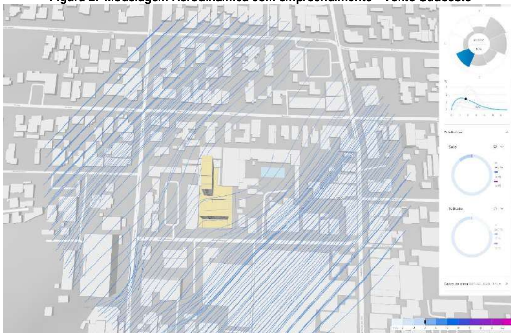
Figura 27 Modelagem Aerodinâmica com empreendimento - Vento Sudoeste
