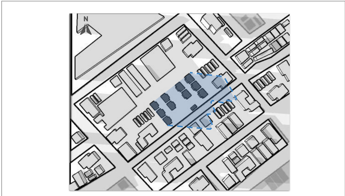
Exemplo de simulação de insolação local no solstício de inverno às 17h.
