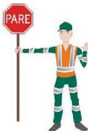
Figura 5: Trabalhador mantendo sinal de “PARE” voltado para o fluxo de veículos e gesto de mão espalmada.
