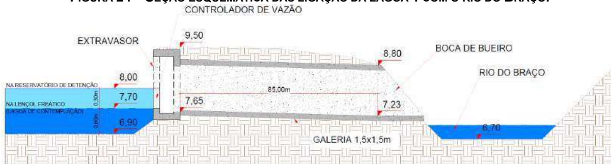
FIGURA 24 – SEÇÃO ESQUEMÁTICA DAS LIGAÇÃO DA LAGOA 1 COM O RIO DO BRAÇO.
