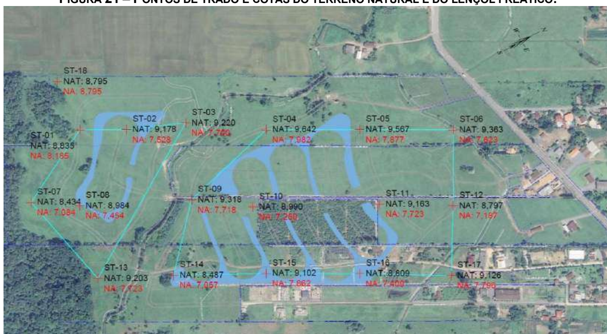
FIGURA 21 – PONTOS DE TRADO E COTAS DO TERRENO NATURAL E DO LENÇOL FREÁTICO.
