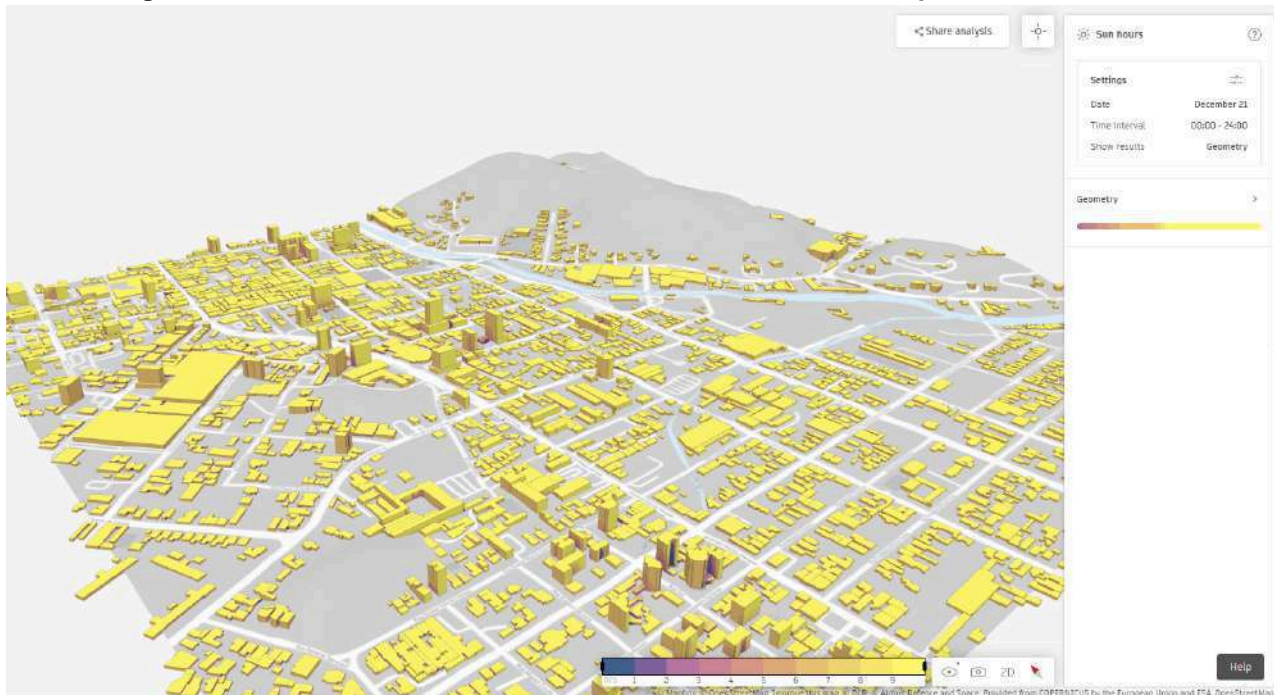
Figura 62. Simulação de incidência solar no solstício de verão, porção sul da OUC
