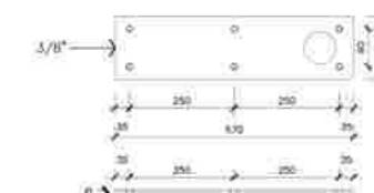
PLANTA BAIXA BASE METÁLICA Escala 1/10
