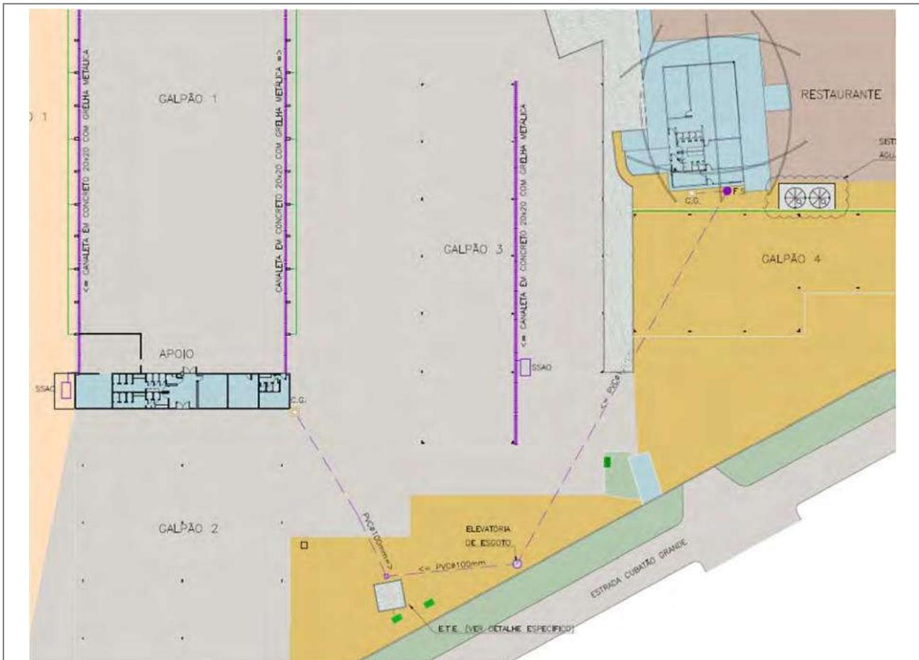
Figura 30 - Planta baixa com a localização do sistema de tratamento de efluentes do Centro Náutico Porto do Sol.
