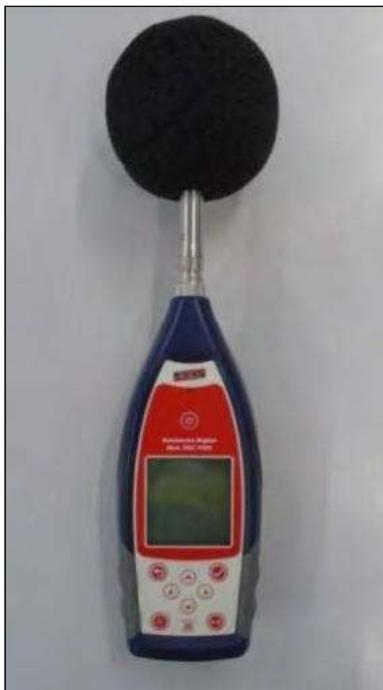
Figura 69 - Sonômetro digital Instrutherm DEC-7000
