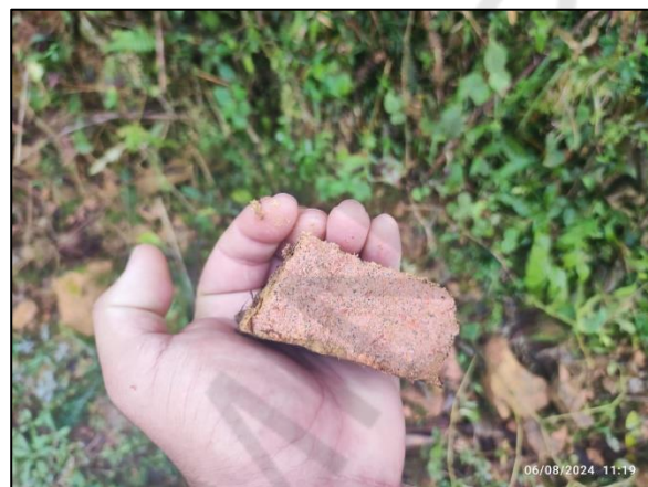
Amostra de gnaiss granulítico com alto grau de alteração
