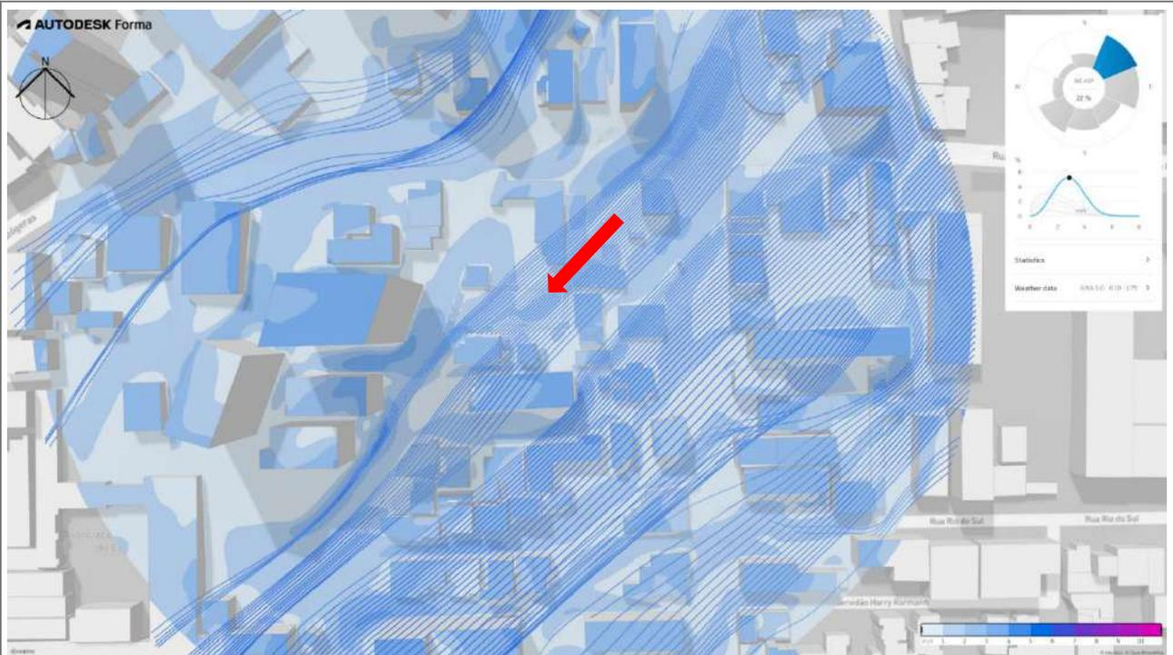
Figura 86: Vento em altura específica – Sentido Nordeste – Sem o empreendimento.
