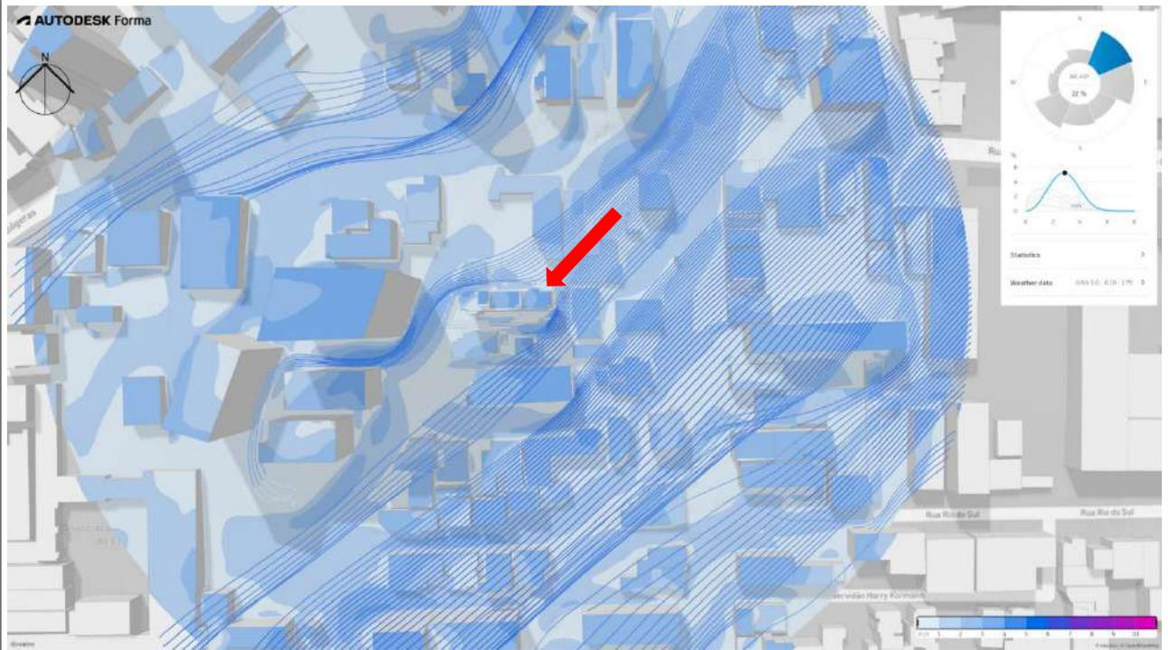
Figura 87: Vento em altura específica – Sentido Nordeste – Com o empreendimento.
