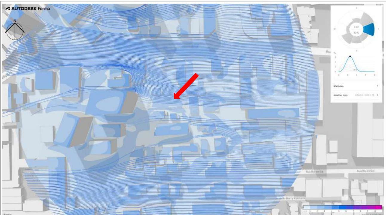
Figura 88: Vento em altura específica – Sentido Leste – Sem o empreendimento.
