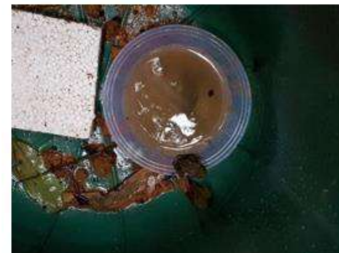
Plataforma de isopor e recipiente com água no interior da armadilha de pitfall
