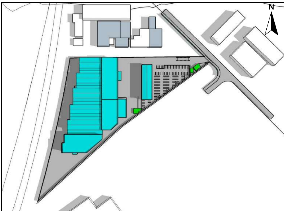
Figura 46 - Simulação de insolação local no solstício de verão às 8h. Fonte: Bioeco, 2024.
