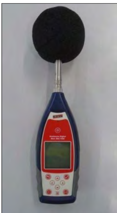
Figura 69 - Sonômetro digital Instrutherm DEC-7000
