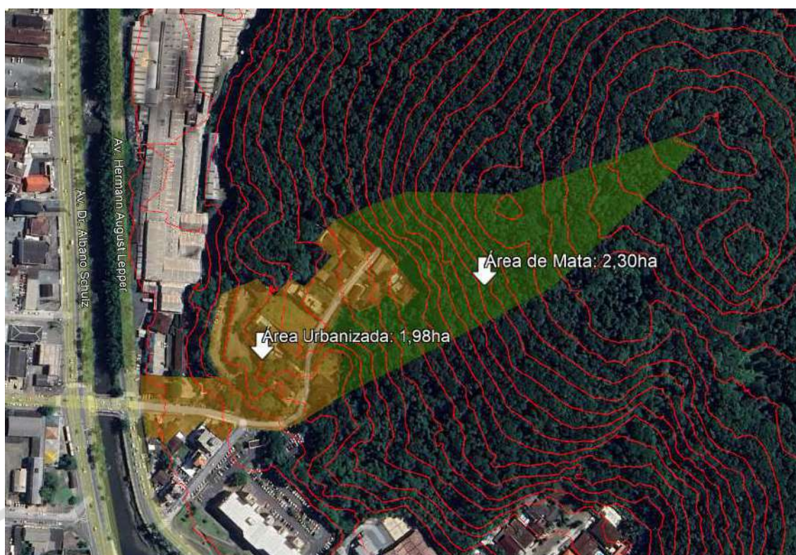
Figura 5 – Delimitação das áreas de mata e impermeabilizadas.
