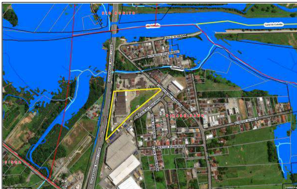
Figura 28 - Mancha de inundação. Fonte: SEINFRA/Unidade de Drenagem - SimGeo (acesso em 15/10/2024).
