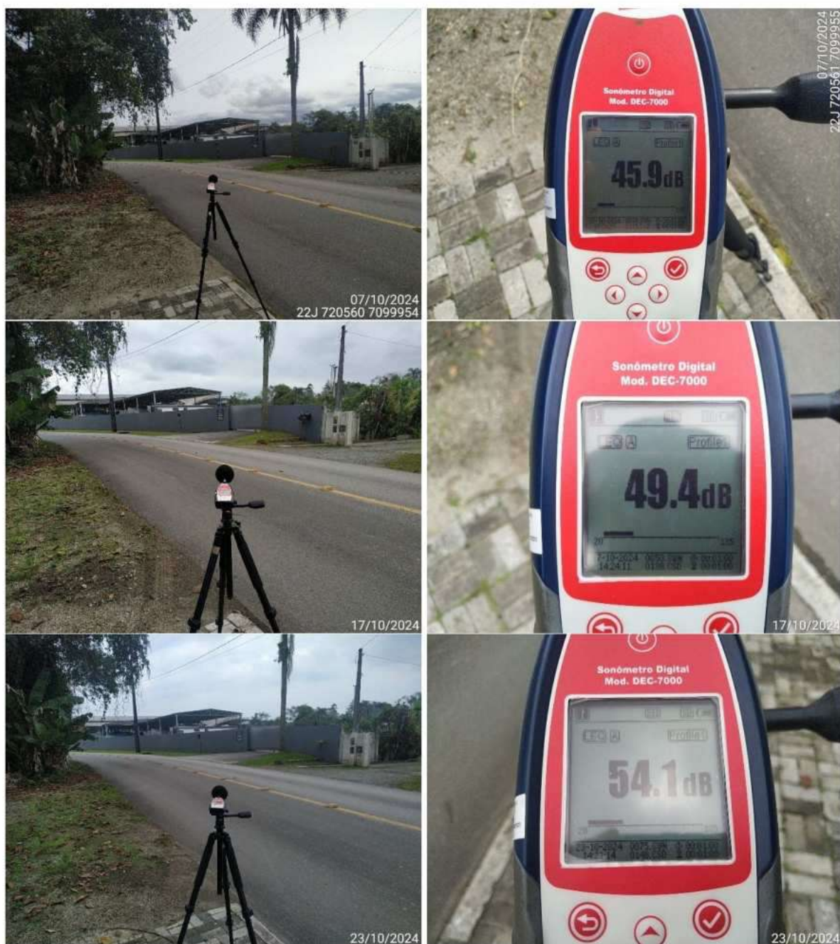
Figura 73 - Registro fotográficos da avaliação de ruído realizada no Ponto 3 contendo local de medição e resultados obtidos.
