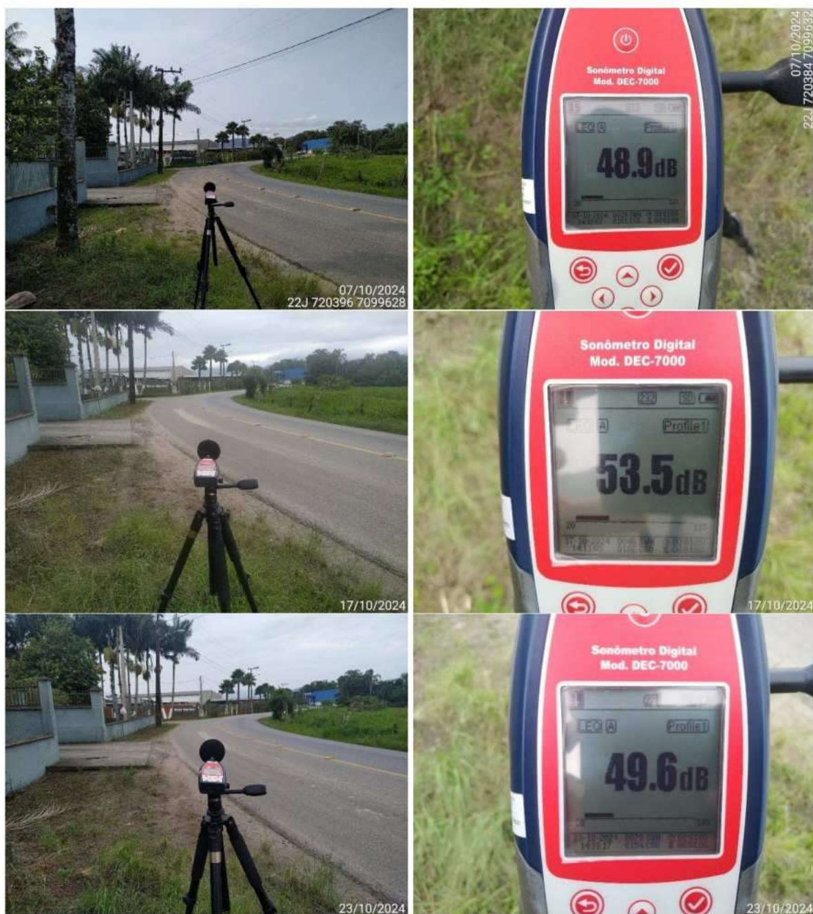
Figura 71 – Registro fotográficos da avaliação de ruído realizada no Ponto 1 contendo local de medição e resultados obtidos.
