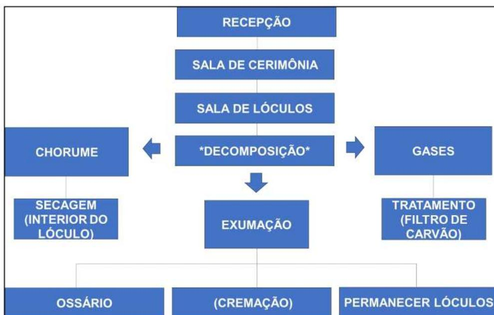
Figura 21. Fluxograma do processo de funcionamento
