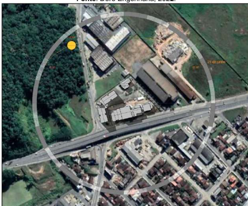
Figura 37. Incidência solar no solstício de inverno (21 de junho), às 15h da tarde Fonte: Doré Engenharia, 2022.
