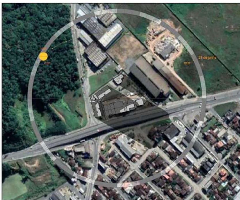
Figura 38. Incidência solar no solstício de inverno (21 de junho), as 17h da tarde Fonte: Doré Engenharia, 2022.
