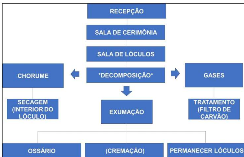
Figura 21. Fluxograma do processo de funcionamento
