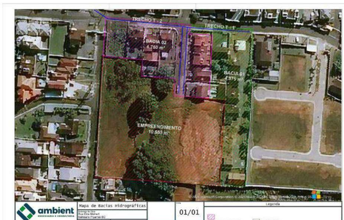
Figura 1 - Mapeamento Áreas de Contribuição Drenagem
