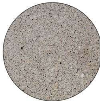
Piso concreto aparente lavado
