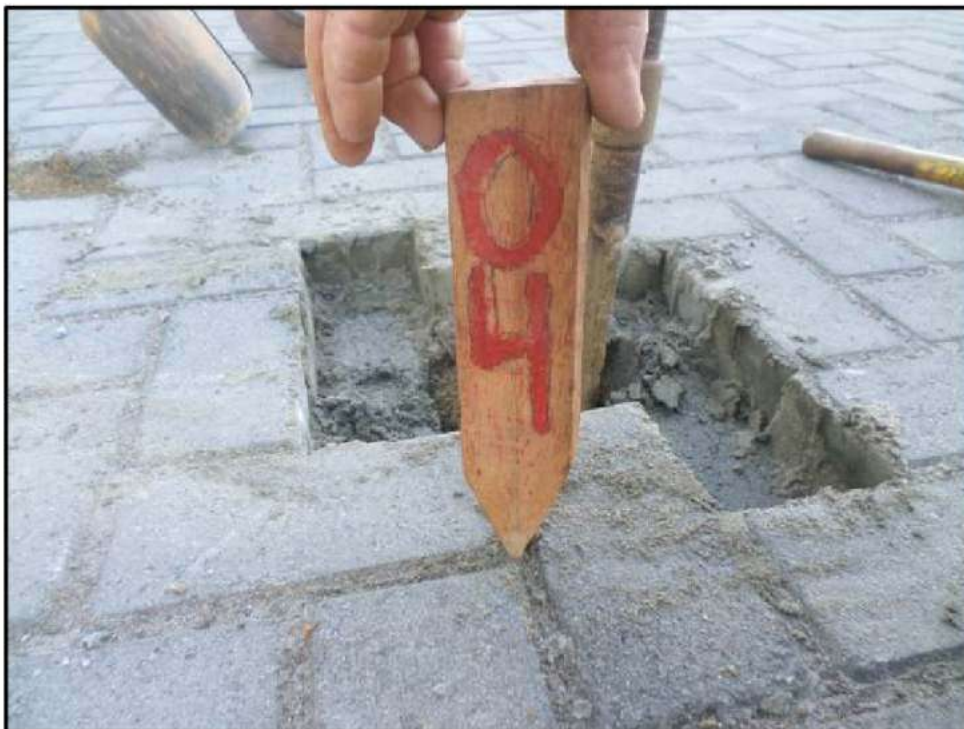
Figura 08 - Locação do furo de sondagem SPT-04.
