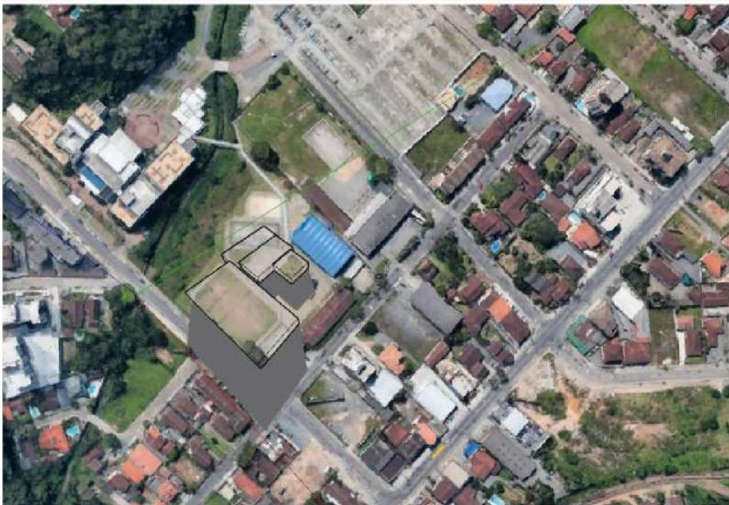
Figura 34 - Simulação de insolação local no solstício de inverno às 17h.
