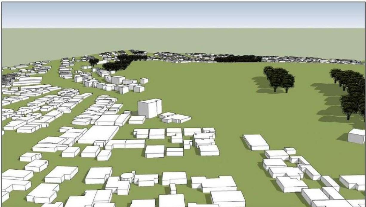
Figura 70. Modelagem dos imóveis do entorno considerando o relevo observado para área de implantação do empreendimento. Fonte: DBio, 2023.
