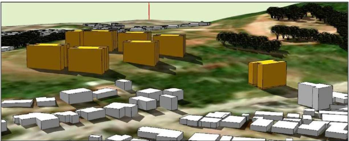
Figura 62. Imagem ilustrativa dos modelos gerados para visualização e quantificação das projeções das sombras para o empreendimento em estudo. Fonte: DBio, 2023.
