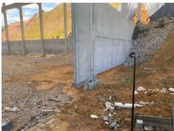
Figura 05: Aferição do nível de pressão sonora no PES -03. Fonte: Pense Verde CSA.
