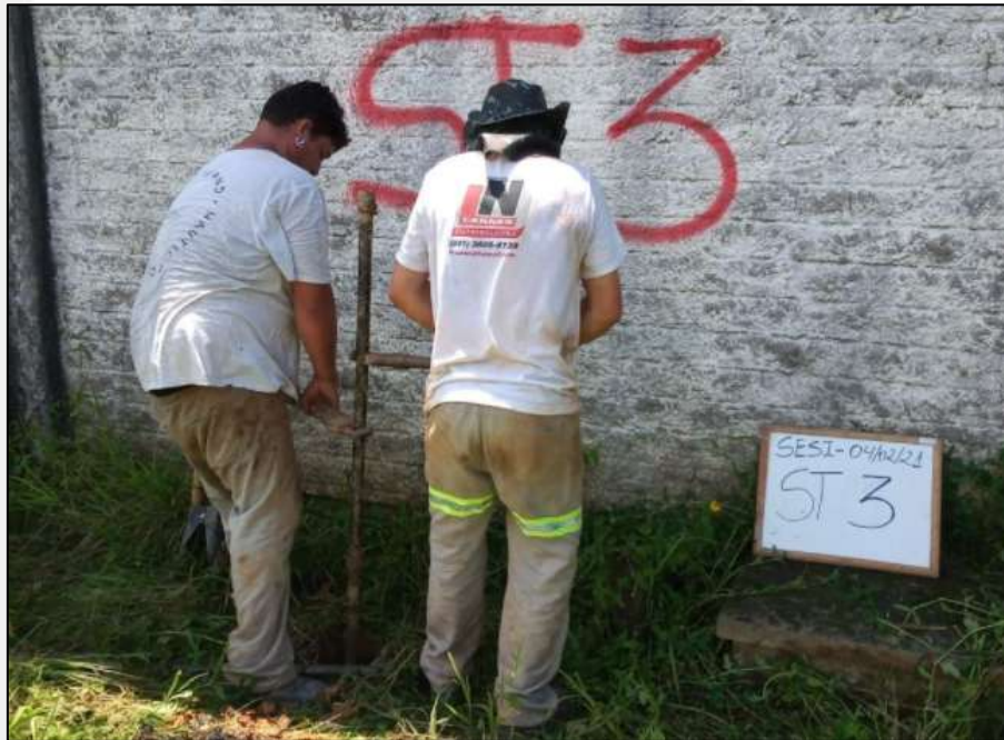
Fotografia 31: Perfuração a trado manual.
