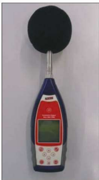
Figura 69 - Sonômetro digital Instrutherm DEC-7000
