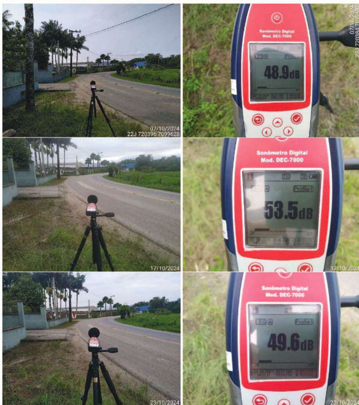
Figura 71 – Registro fotográfico da avaliação de ruído realizada no Ponto 1 contendo local de medição e resultados obtidos.
