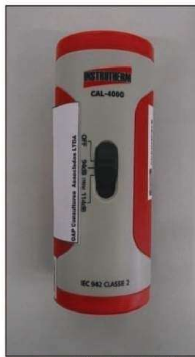
Figura 70 - Calibrador Instrutherm CAL-4000.
