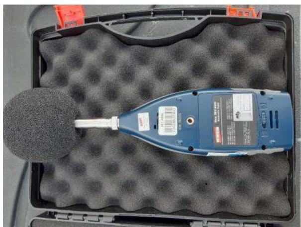
Foto 10-21: Detalhe do sonômetro (decibelímetro) modelo DEC 6000.
