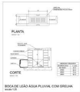
**BOCA DE LEÃO ÁGUA PLUVIAL COM GRELHA**
