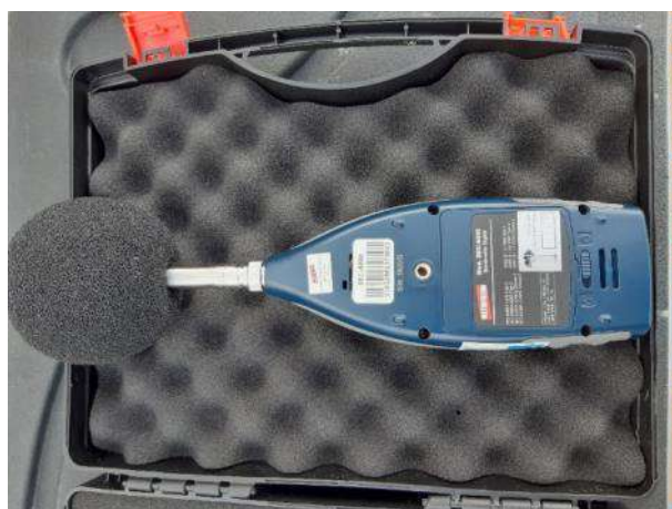
Foto 10-21: Detalhe do sonômetro (decibelímetro) modelo DEC 6000.
