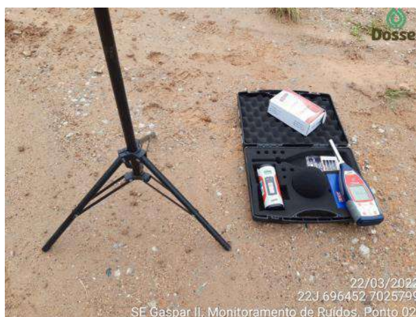
Foto 10-23: Tripé, sonômetro (decibelímetro) modelo DEC 6000, e calibrador de nível sonoro utilizados no monitoramento.
