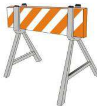
Figura 67: Exemplo de barreira móvel com cavalete.
