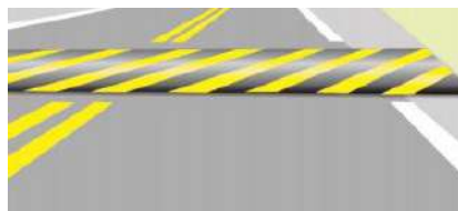
Figura 64: Ondulação transversal para redução de velocidade.
