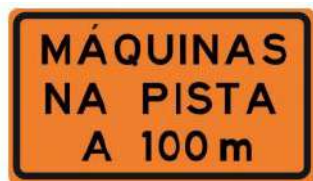
Figura 63: Indicação de obras à frente.
