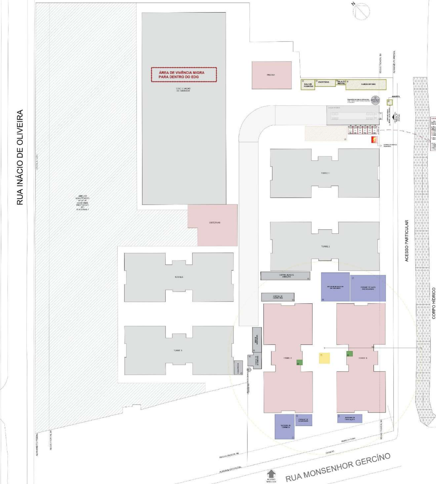
IMPLANTAÇÃO - LAYOUT DO CANTEIRO DE OBRA - FASE 3 ESCALA 1:250
