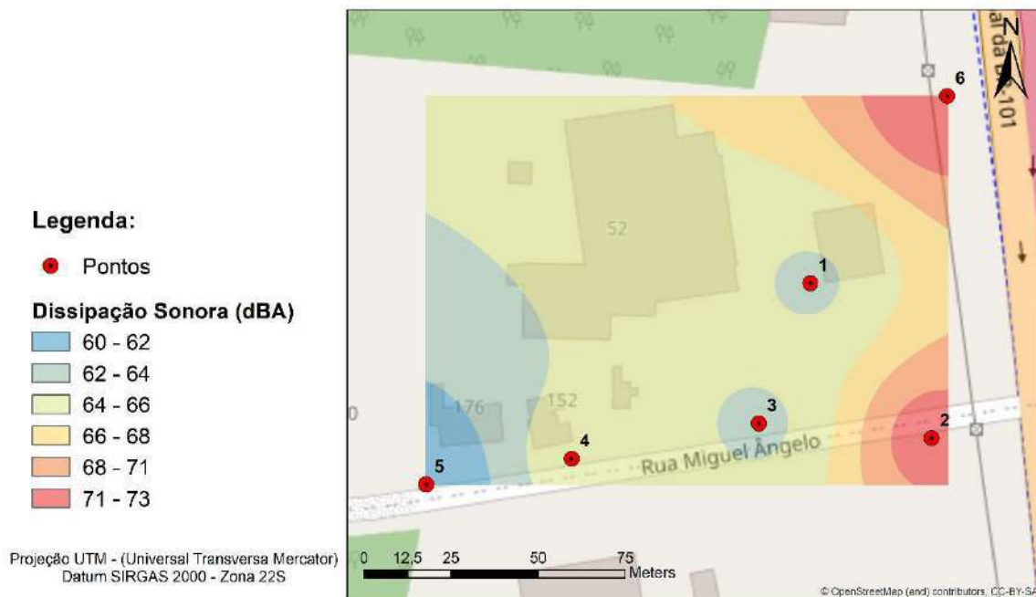
Figura 31. Dissipação sonora com forno de cremação não operando.
