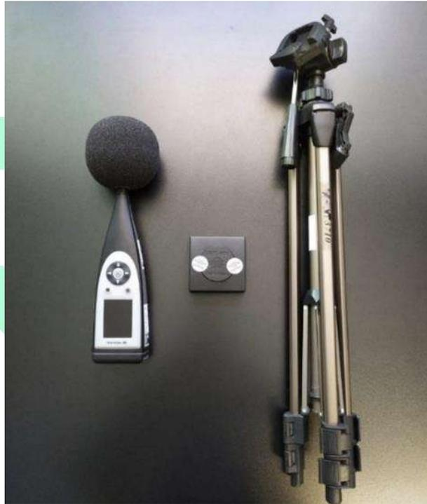
Figura 42: Equipamentos utilizados para medição de ruído.
