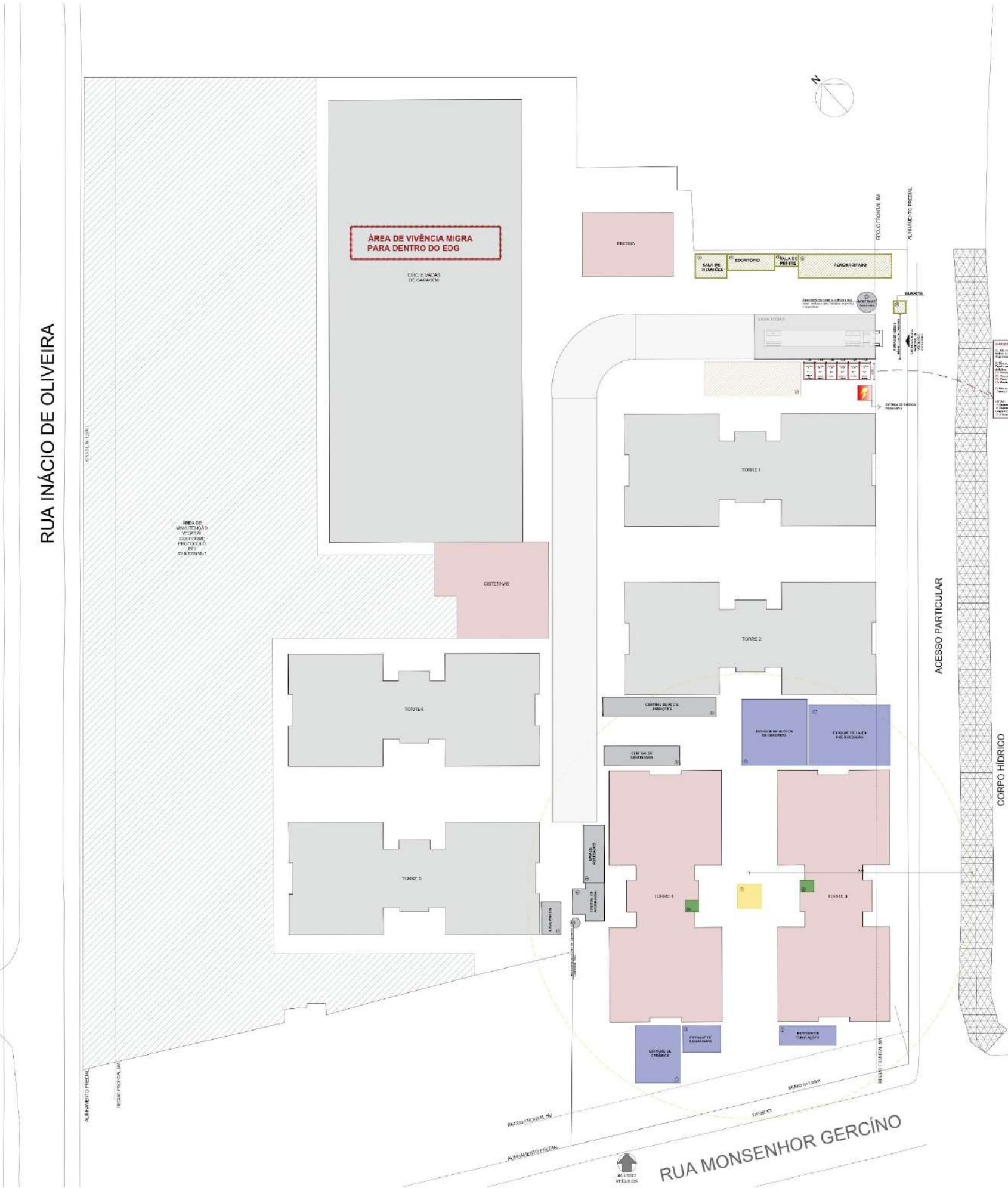
IMPLANTAÇÃO - LAYOUT DO CANTEIRO DE OBRA - FASE 3 ESCALA 1:250
