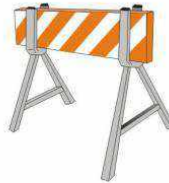
Figura 67: Exemplo de barreira móvel com cavalete.
