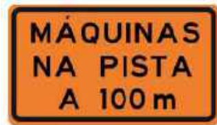
Figura 63: Indicação de obras à frente.
