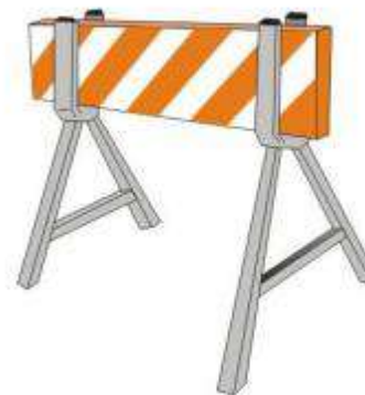
Figura 68: Exemplo de barreira móvel com cavalete.
