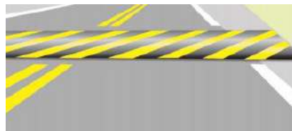
Figura 65: Ondulação transversal para redução de velocidade.
