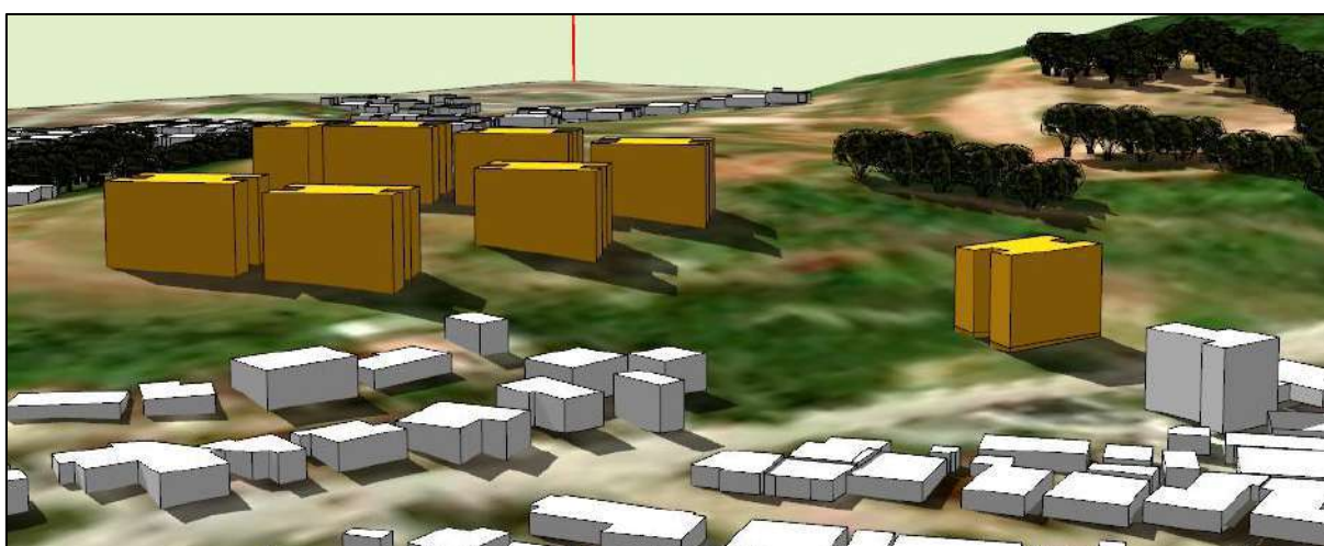
Figura 64. Imagem ilustrativa dos modelos gerados para visualização e quantificação das projeções das sombras para o empreendimento em estudo. Fonte: DBio, 2023.
