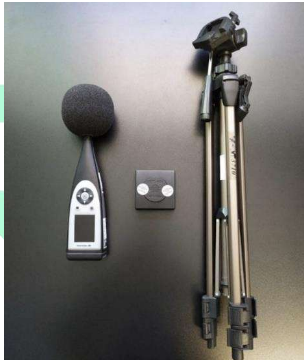
Figura 42: Equipamentos utilizados para medição de ruído.
