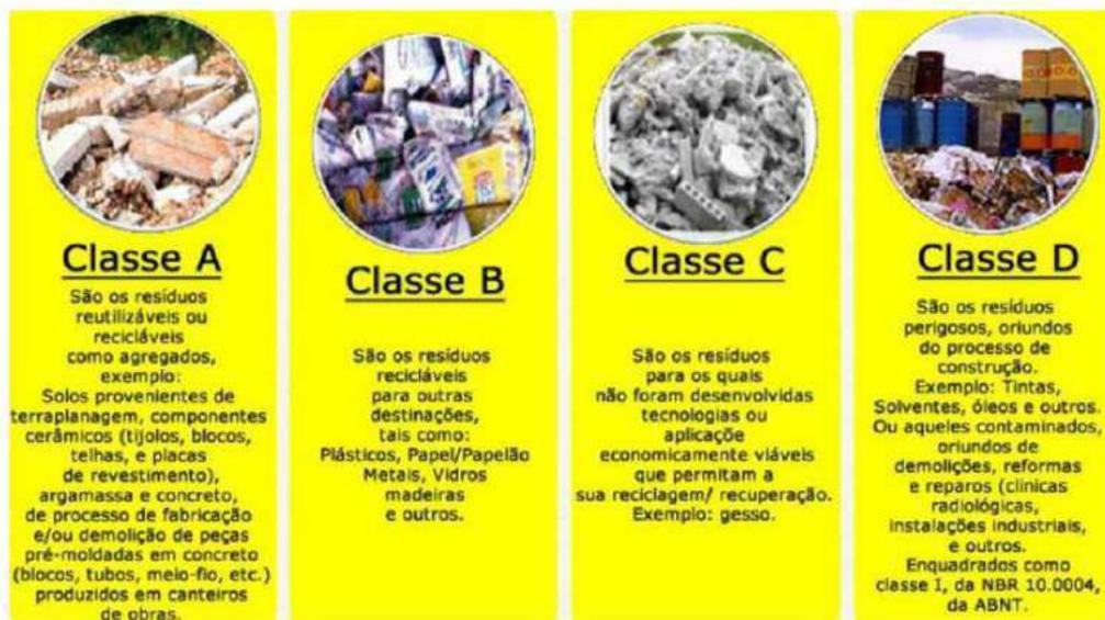
Figura 26. Classificação dos resíduos da construção civil.
