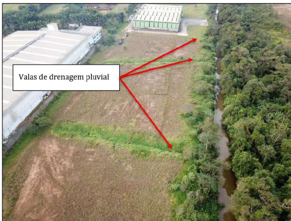
Figura 8 - Localização das valas de drenagem.
