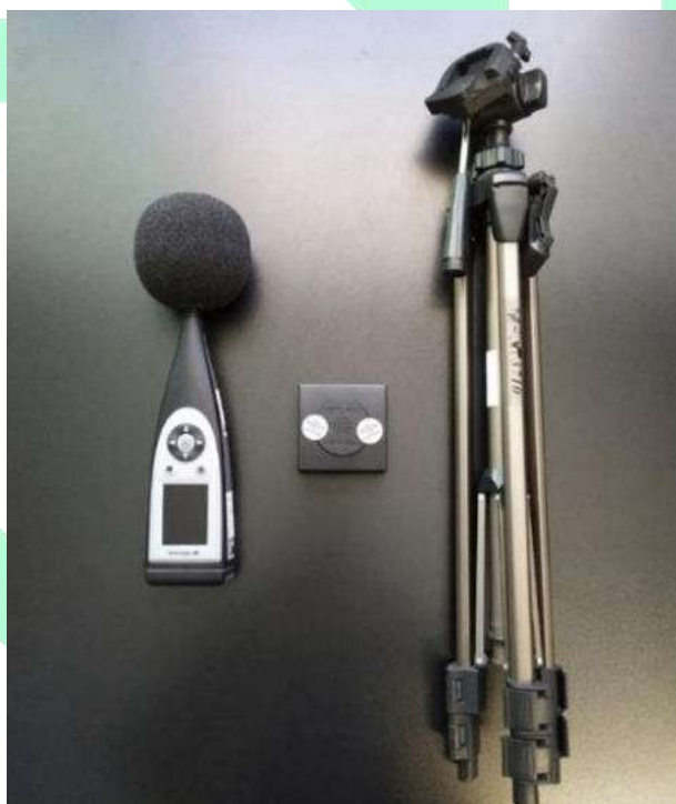
Figura 42: Equipamentos utilizados para medição de ruído.
