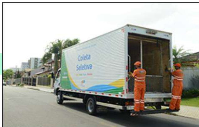
Figura 55: Veículo específico para coleta de resíduos recicláveis.
