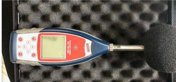
Figura 68: Sonômetro Digital – DEC -6000.
