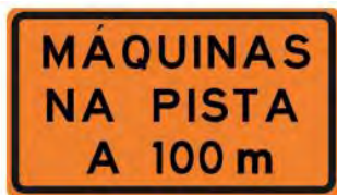
Figura 59: Indicação de obras à frente.
