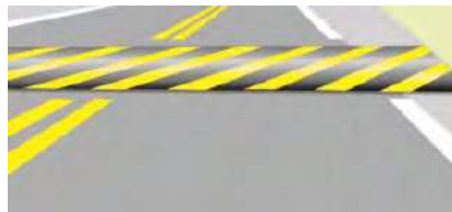
Figura 60: Ondulação transversal para redução de velocidade.
