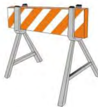
Figura 63: Exemplo de barreira móvel com cavalete.
