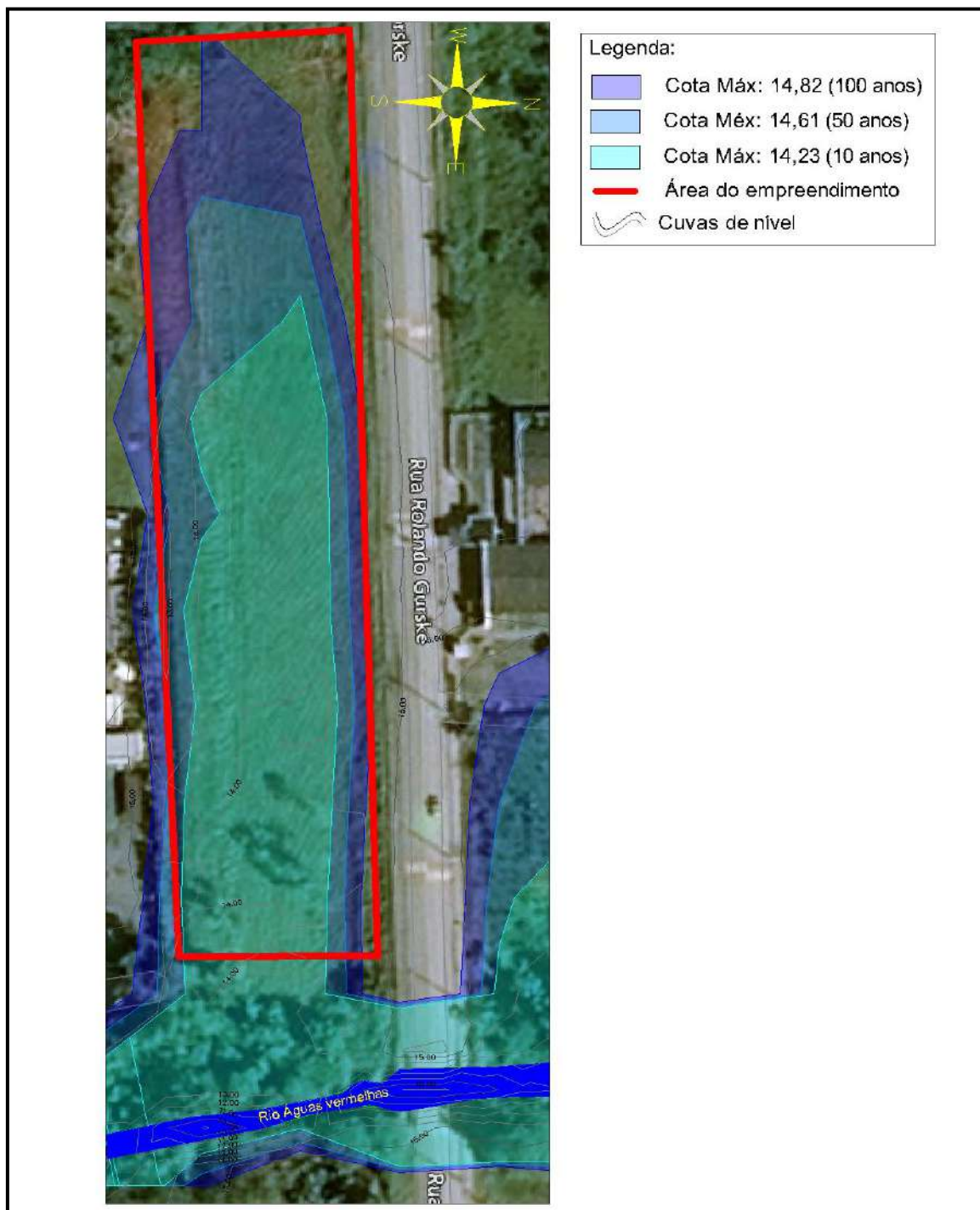
Figura 24. Disposição da área diretamente afetada em relação à simulação (HEC- RAS) por período de retorno de 10 a 100 anos
