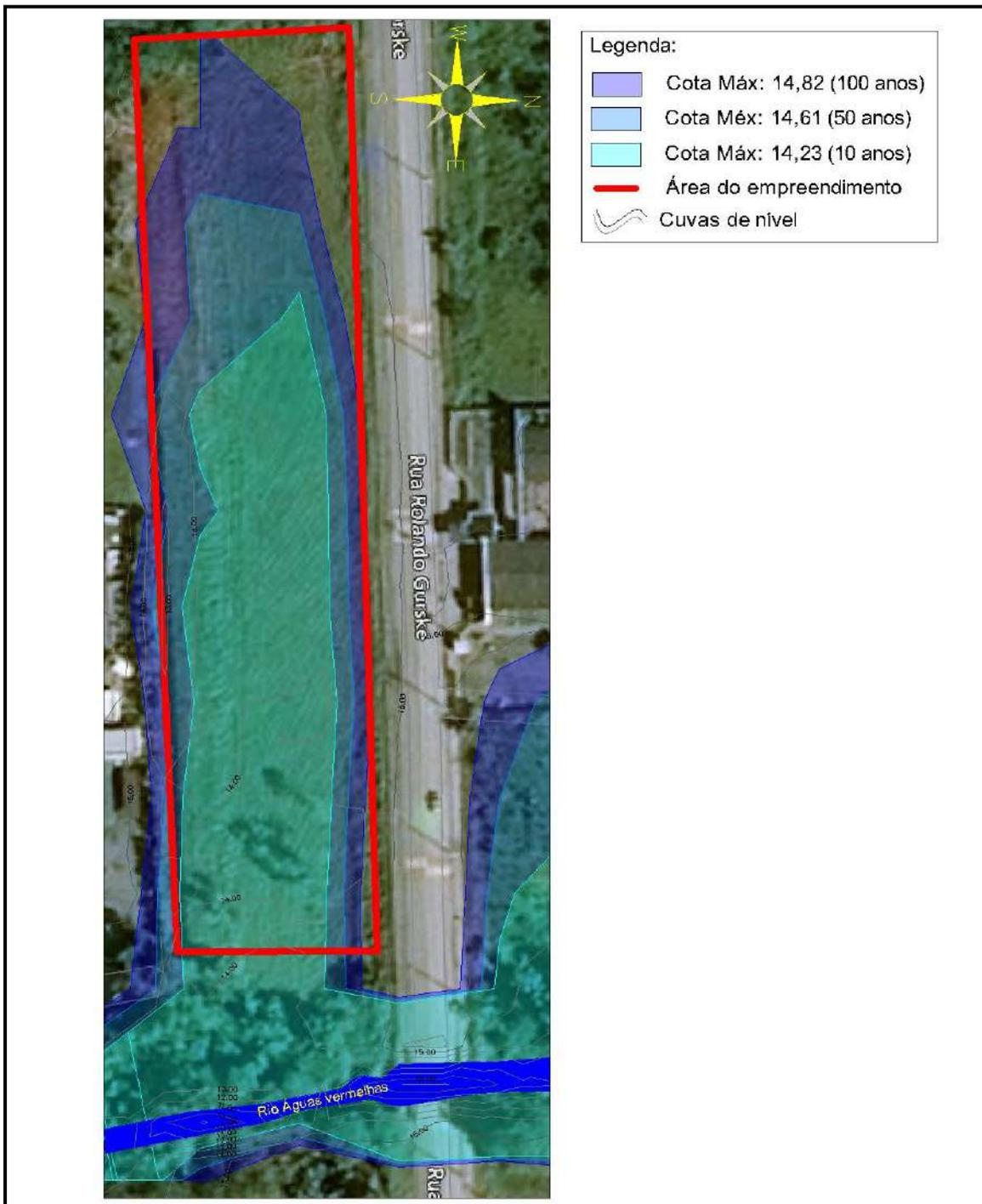
Figura 15. Disposição da área diretamente afetada em relação à simulação (HEC- RAS) por período de retorno de 10 a 100 anos
