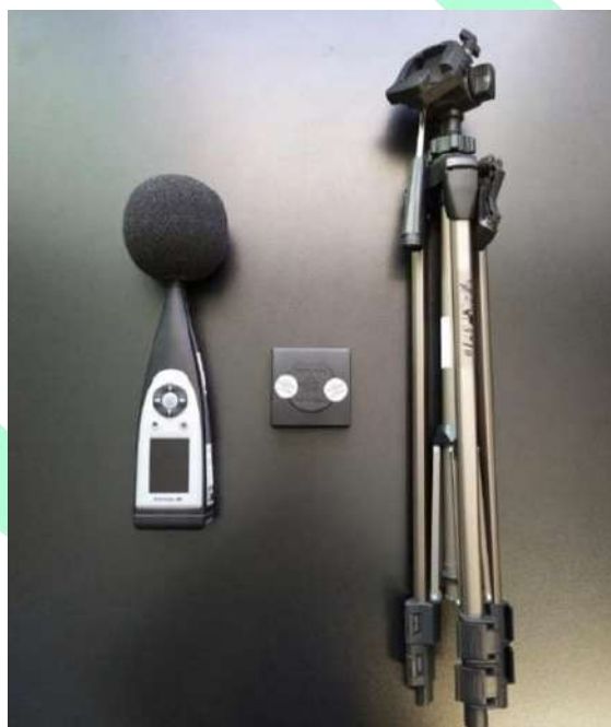
Figura 42: Equipamentos utilizados para medição de ruído.
