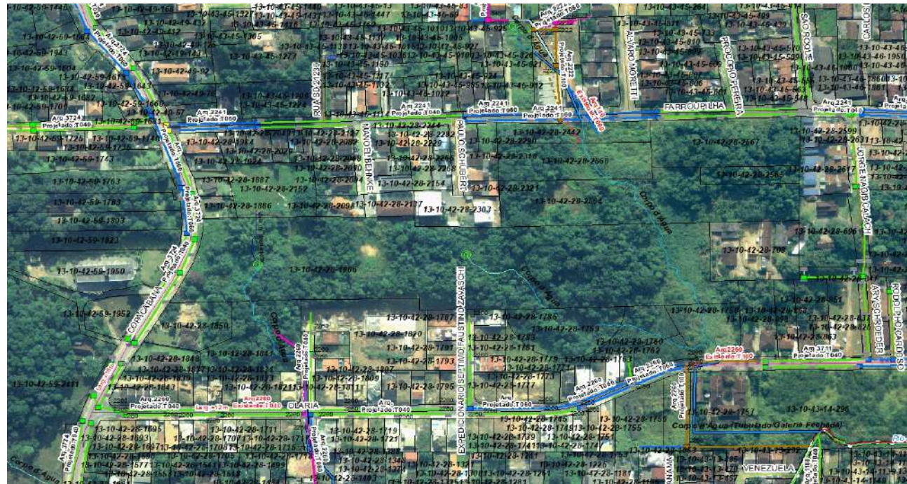
Figura 2. Rede de drenagem e corpo d'água Fonte: SEINFRA/Unidade de Drenagem - ArcGis (acesso em 21/02/2024)
