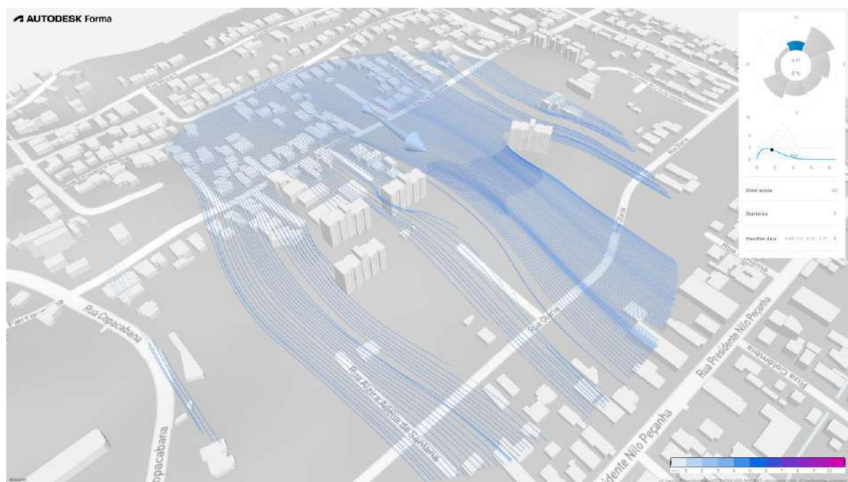
Figura 63: Vento em altura específica – Sentido Norte – Com o empreendimento.
